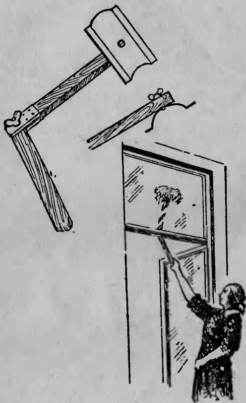
Рис. 1. Приспособление для мытья стекол.
