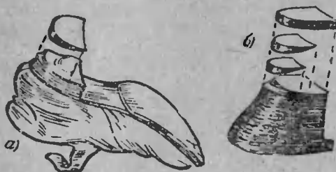
Рис. 28. Ремонт каблука.
